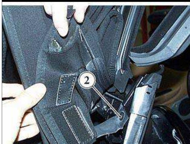
● 提起帆布并拆卸将橡胶带紧固至接头臂的螺钉(2)。
