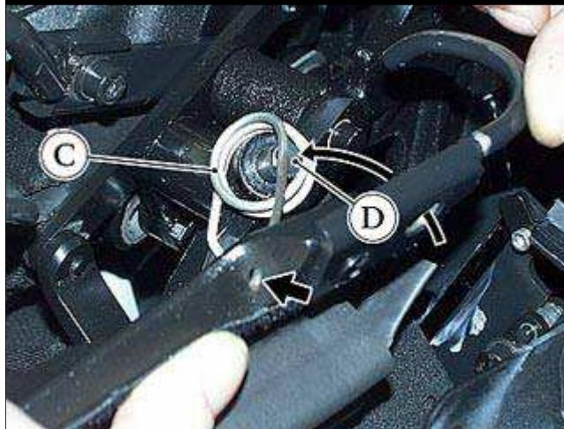
● 将弹簧(C)的直端插入接头臂孔并对应销(D)将其移动。
