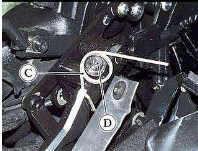
● 将弹簧(C)放置到销(D)上 (将折叠端连接到主支撑下方)。
