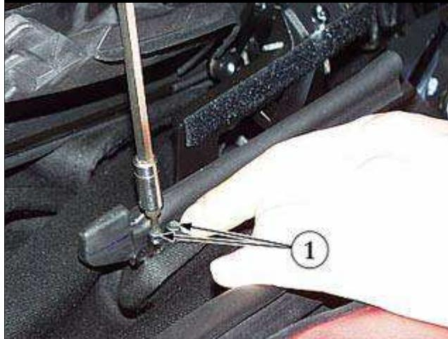
● 拆卸将帆布立柱固定至接头臂的螺钉(1)。
