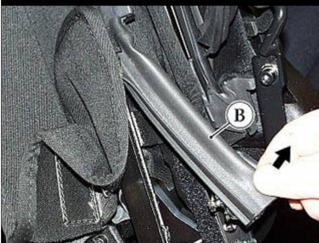
● 密封圈(B)被插入接头臂的带槽轮廓中。为了更换它，必须从其座中将其拔出并从前端滑下。
