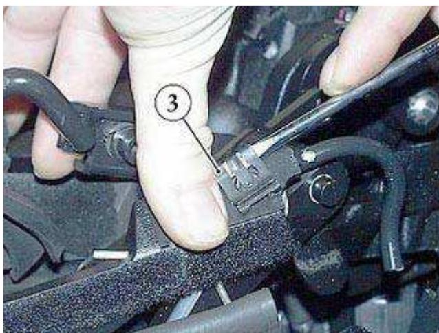
● 安装新的弹簧夹(3) (确保它完全处于销座中)。
