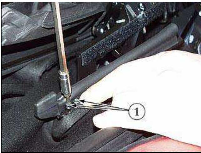
● 使用螺钉(1)将帆布紧固到接头臂上。
